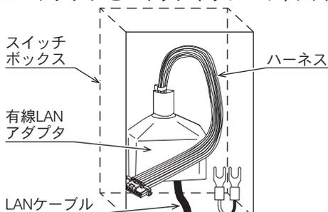
注) LANケーブルの曲げ半径は25mm以上になるように注意してください。
