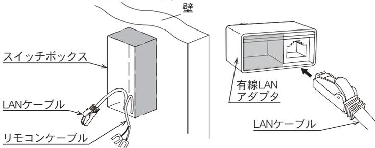
※リモコンケーブルとLANケーブルはスイッチボックス下部の別の開口部から引き込むことを推奨します。
