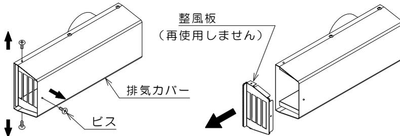
② 本体と取付板を排気の方角に応じて組み立てます。開口部（アミ側）が必ず上向きになるようにしてください。
