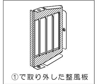
④ ③完を排気カバーに取り付け、①で外したビス3本で固定します。
