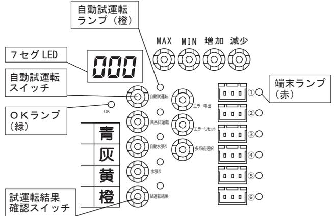
※信号線が接続されている接続端子に対応した端末ランプ(赤)が点滅した場合は、試運転エラーですので、対応する端末または機器の状態を確認し、その後、再度自動試運転を行ってください。その場合、前回正常に試運転を終了した端末の試運転は省略します。(作業手順②で一度ランプはすべて点灯しますが、5～10秒後に正常終了した系統のランプは消灯し、試運転を行いません。)
