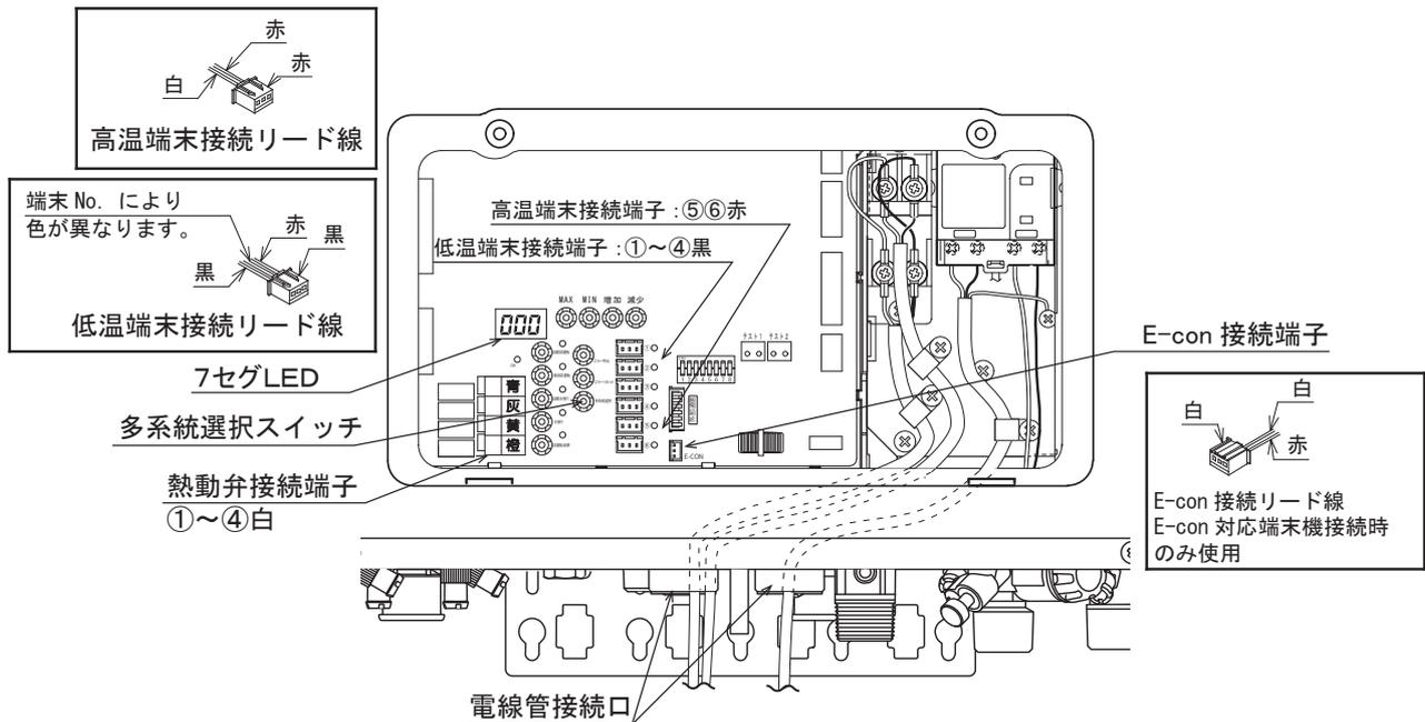
◆電装基板の低温端末接続端子(黒コネクタ①～④)は高温・低温兼用です。
