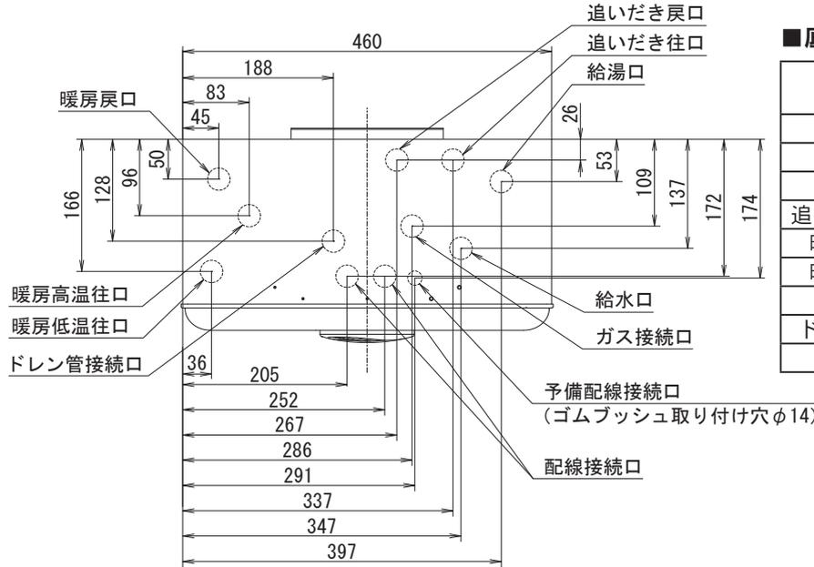
■底板よりの各継手高さ・各配管口径
