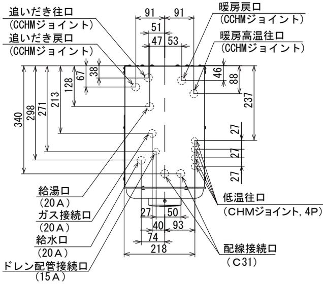
■各配管口径と底板よりの継手高さ
