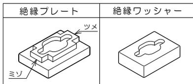
1. 絶縁プレートのミソを壁固定金具にはめ込むように入れる。
