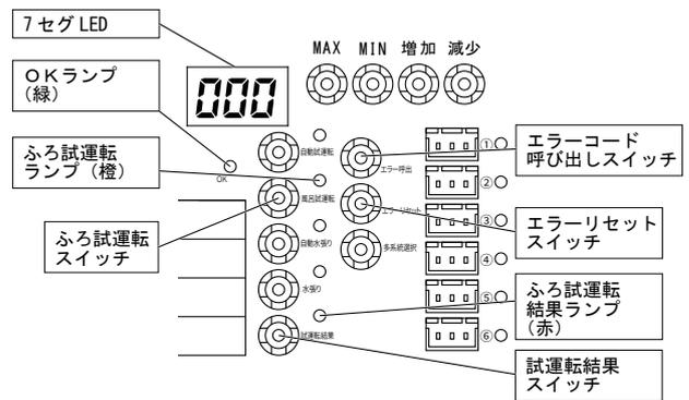
◆ふろ試運転が正常でない場合、途中で停止し、ふろ試運転ランプ(橙)が消灯し、ふろ試運転結果ランプ(赤)が点滅し、リモコンにエラーコードを表示します。電装基板上のエラーコード呼び出しスイッチを押すとエラーコード表示部にエラーコードを表示します。ふろ試運転結果ランプは約24時間点滅した後消灯します。
