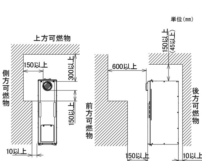
側面設置(左右側面設置可能)
