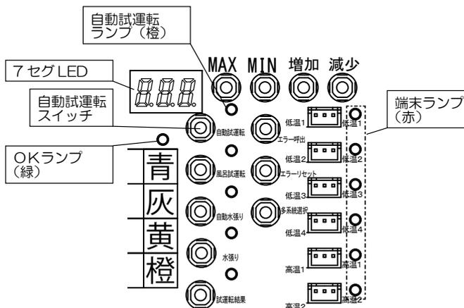
※信号線が接続されている接続端子に対応した端末ランプ(赤)が点滅した場合は、試運転エラーですので、対応する端末または機器の状態を確認し、その後、再度自動試運転を行ってください。その場合、前回正常に試運転を終了した端末の試運転は省略します。(作業手順2.でいったんランプがすべて点灯しますが、5～10秒後に正常終了した系統のランプは消灯し、試運転を行いません。)
