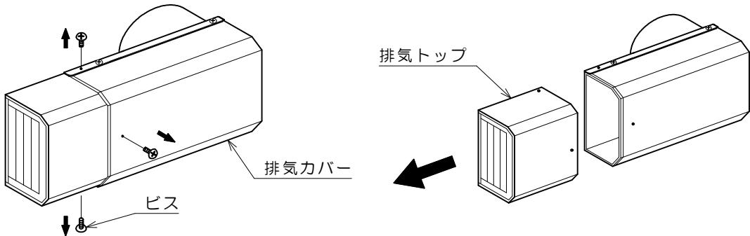
②斜方排気アダプターを、外したビス3本で取り付けます。
