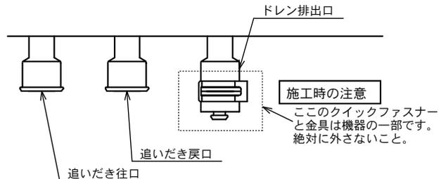
ふろ配管水漏れ検査
