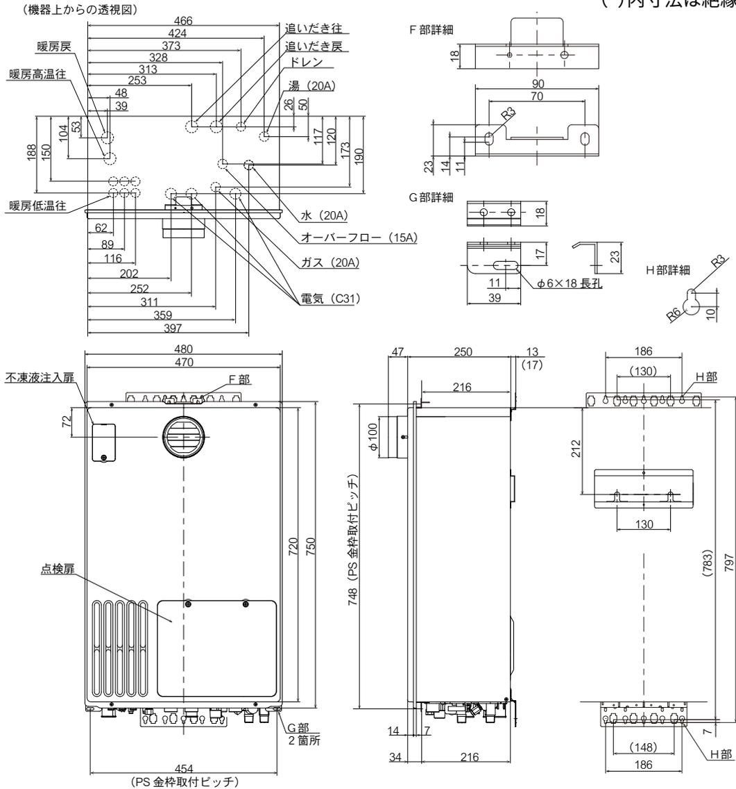
■各配管口径と底板よりの継手高さ (mm)
