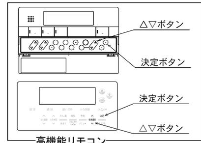
4. 【標準リモコン】給湯温度表示部を下表で変更したい温水温度（低温行き温度）番号に給湯温度の△▽ボタンで合わせ、「音量」ボタンを押し。
