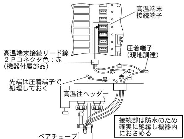
(電装基板のイラストは熱動弁6P内蔵タイプを示す)
