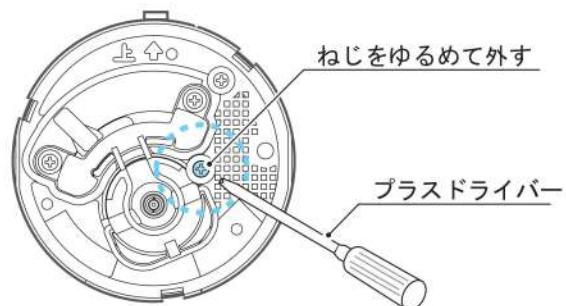
※ノズル固定ねじを取り外す場合は、ねじを排水溝に落とさないように注意してください。
