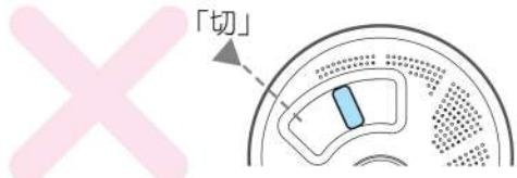
※ウルトラファインバブル切替レバーは途中で止めず、必ずレバーが止まる位置まで動かしてください。
