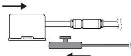
⑥ ワイヤーを調整し、浴槽上縁部裏側にできるだけ近い位置に吸気ユニットが来るよう設置してください。
