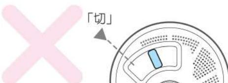
※ウルトラファインバブル切替レバーは途中で止めず、必ずレバーが止まる位置まで動かしてください。
