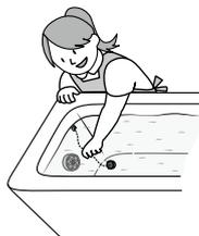
残り湯の水位が循環口より低くなると、自動配管クリーンが始まります
