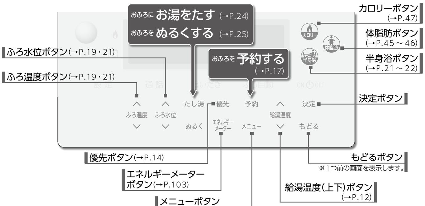
省電力機能(→P.94)がはたらくとON/OFFボタン以外すべて消灯します。サブボタンは設定ボタンを押しても消灯します。
