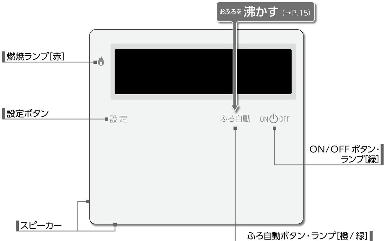
**【サブボタン表示時】** 以下のボタンは、設定・給湯温度ボタンを押すと点灯します。
