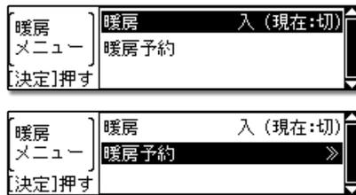
※現在時刻が設定されていない場合、**暖房予約** を選択して **決定** を押すと「ピピピッ」受け付け禁止音が鳴ります。
