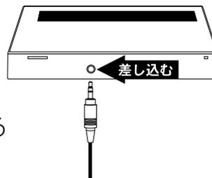
接続コードのプラグを、音楽プレーヤーなどの出力端子(イヤホン端子やヘッドホン端子など)と台所リモコンの入力端子に差し込み、つなげます。
