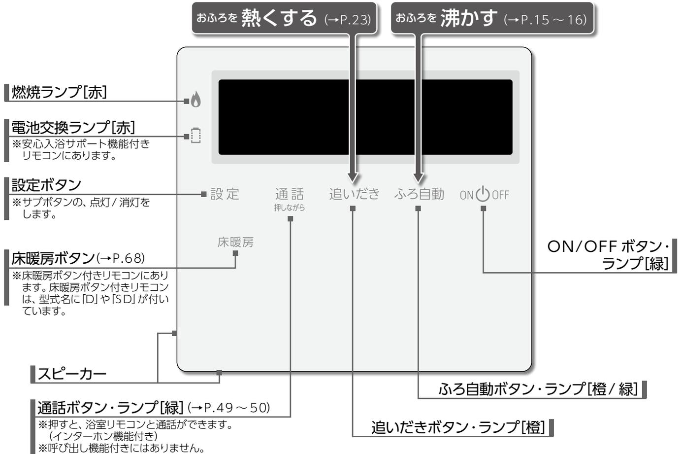
**【サブボタン表示時】** 以下のボタンは、設定・給湯温度ボタンを押すと点灯します。
