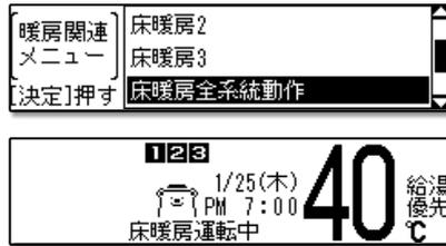
※接続されている床暖房が1系統の場合 **床暖房全系統動作** は表示しません。
