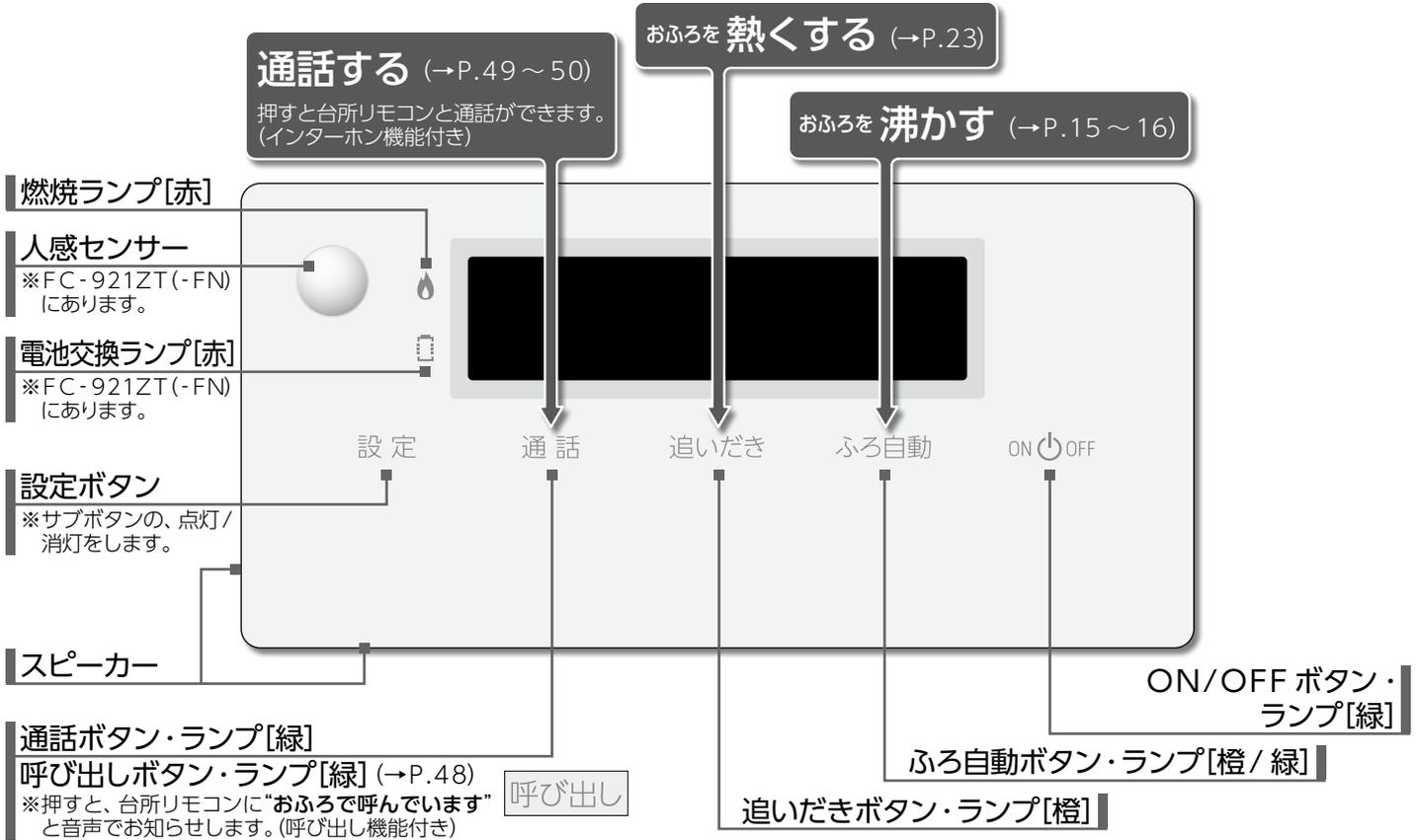
**【サブボタン表示時】** 以下のボタンは、設定・風呂自動・追いだき・給湯温度ボタンを押すと点灯します。
