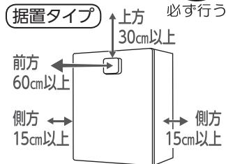
\*壁掛タイプで型式名の末尾に“B”的つく製品の離隔距離は、側方15cm以上になります。
