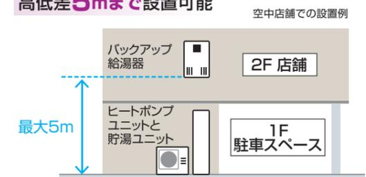
バックアップ給湯器は貯湯ユニットとの距離を高低差5m、配管長10mまでとることができます。また、ヒートポンプユニットは貯湯ユニットとの距離を高低差3m、配管長15mまでとることができます。
