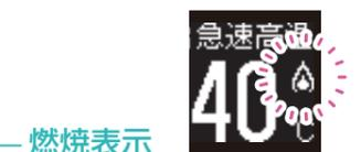
バックアップ給湯器が燃焼を開始すると表示されます。
